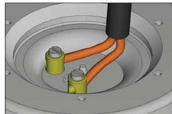
Mettre les fils dans les connecteur, serrer fermement les vis.
