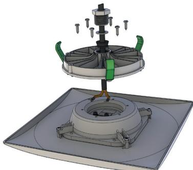
Mise en place des cosses sur les connecteur puis serrer fermement les vis.
