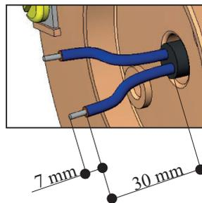
Faire passer à travers le connecteur. / Made to pass through the connector.
